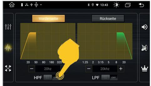
In diesem Menü können Sie einen Hoch- und/oder Tiefpassfilter für das Audiosignal aktivieren. Bringen Sie den jeweiligen Schalter in die Position **ON** und wählen Sie die gewünschte Trennfrequenz aus.
